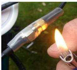
**ATTENTION :** Il est très important de mettre une gaine thermo-rétractable à chaque raccord antenne/câble. Avant de faire chauffer la gaine, s'assurer que les connecteurs soient correctement verrouillés.
