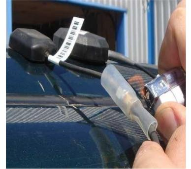
Brancher le câble GPS à l'antenne GPS et faire venir la connectique GPS (SMA) au niveau du support.
