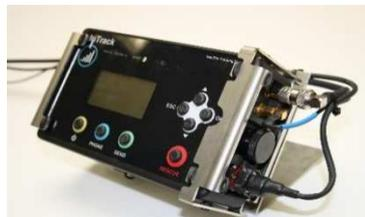
Fixation sur le tableau de bord à l'aide d'une plaque métallique pliée.
