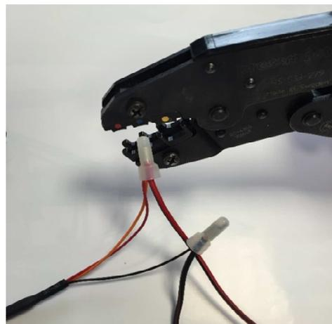
**Vous pouvez si vous le souhaitez, et si la configuration du véhicule vous le permet, connecter directement le câble d'alimentation 1m au porte fusible**
