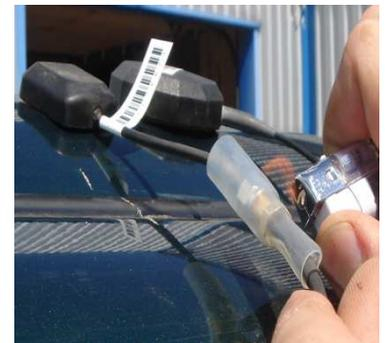
Brancher le câble GPS à l'antenne GPS et faire venir la connectique GPS (SMA) au niveau du support.
