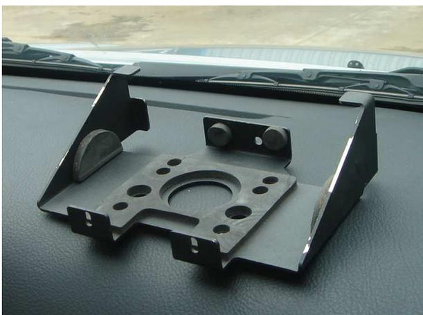
Le support peut être fixé sur le tableau de bord. Les boutons de l'Iritrack doivent être visibles et accessibles par le pilote et copilote pour appui en cas d'urgence.
