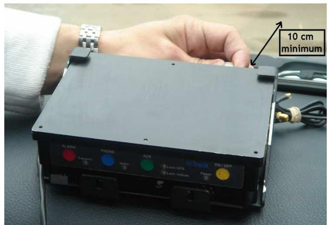
Il est indispensable d'avoir de la place suffisante afin de pouvoir passer les doigts à l'arrière du boîtier pour vérifier la connexion des câbles : environ 10cm.
