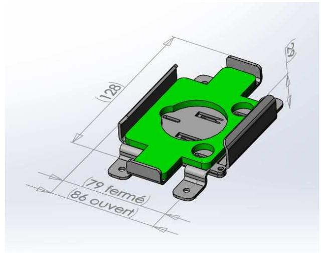
La altura total de la Smalltrack, cuando está instalada en el soporte es de 50mm (29mm por el soporte solo). El soporte debe ser fijado al vehículo por los 4 puntos de fijación
