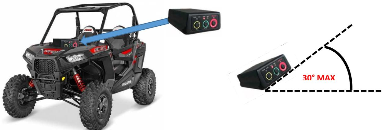
Merci de fixer le support de la Smalltrack à l'avant de votre SSV. Comme nous vous l'indiquons, l'inclinaison ne doit pas être supérieur à 30° afin d'optimiser la réception du signal satellite.
