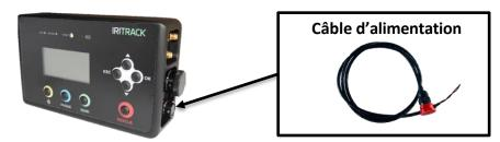
L'Iritrack doit être alimenté en permanence du début à la fin du rallye. Le câble d'alimentation doit être connecté directement à la batterie ou à la boite à fusible de votre véhicule (pas de breaker fusible).
