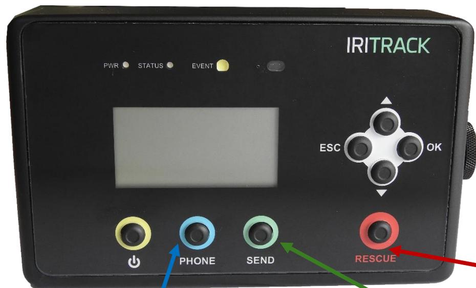
Les boutons doivent être enfoncés (3 secondes) jusqu'à ce que la LED « STATUS » clignote et que l'indication d'envoi apparaisse à l'écran.
